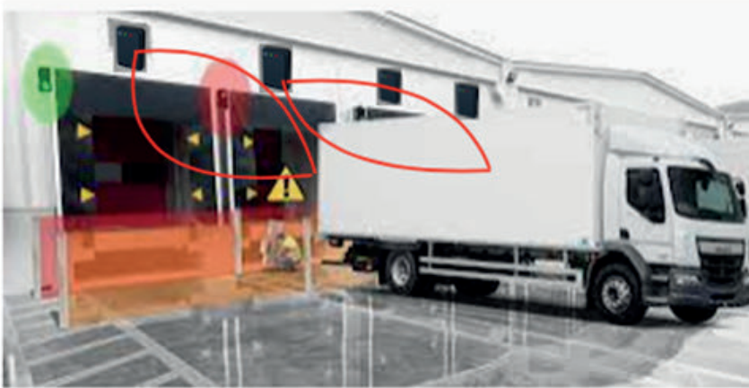
Überwachung der Ankunft und Abfahrt von Lastwagen an einer Außenverladestation.
